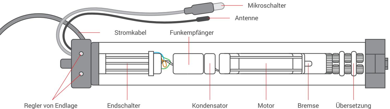
Die maximale Arbeitszeit vom Antrieb beträgt 4 Minuten. Nach dieser Zeitübertritt schaltet sich Wärmeschutz ein, der den Motor zu trennen wird und schützt den Antrieb vor Überhitzung. Nach der Aktivierung des Thermoschalters, warten Sie bitte ca. 20 Min., damit wieder den Antrieb in der normalen Betriebsart zurückfahren kann.
