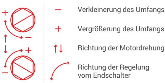
Um die untere oder obere Endlage einzustellen, soll man den Rollläden in der Schließrichtung oder Öffnungsrichtung aufmachen, bis sich in der eingestellten Fabriklage stoppt. Um den Umfang zu erhöhen, muss man einem entsprechenden Knopf auf in die Richtung "+" umdrehen. Wenn der Bereich zu groß ist, muss es reduziert werden und in die Richtung "-" umdrehen.
