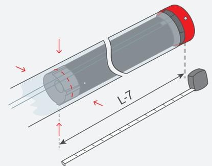
6. Montieren Sie das Wickelrohr auf den Mitnehmer, mit Hilfe von vier Schrafschrauben oder Nieten, die in einem Abstand L-7 mm von Innenkante des Kopfes gestellt sind.
