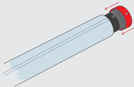
5. Stecken Sie den Antrieb zu dem Wickelrohr, so dass die Kante des Wickelrohres an der Innenkante des Kopfes anliegt.
