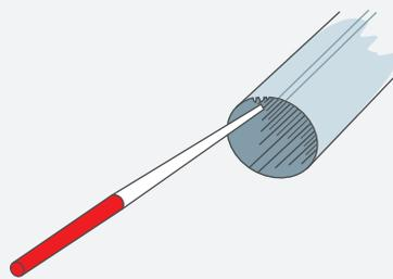
2. Entfernen Sie Feilstäube und Graten von dem Rand des Wickelrohrs.
