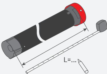
4. Messen Sie die Länge L zwischen der Innenkante des Kopfes und mit dem Aufsatz des Mitnehmers.
