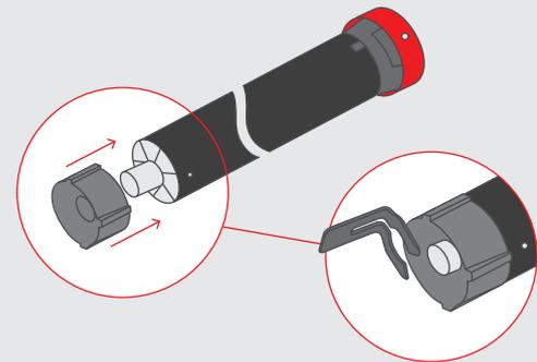
3. Montieren Sie Adapter auf dem Antrieb.
